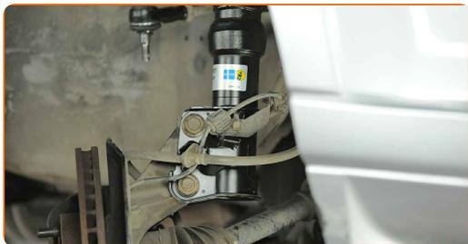
**55** Ziehen Sie den ABS-Kabelhalter an. Verwenden Sie Stecknuss Nr. 10. Verwenden Sie einen Ratschenschlüssel.
