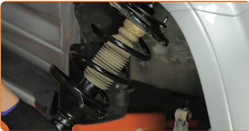
**43** Schrauben Sie die obere Befestigung des Federbeinbefestigung an.
