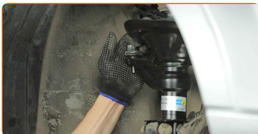
**57** Ziehen Sie die Befestigungsmutter an, die den Spurstangenkopf mit dem Achsschenkel verbindet. Verwenden Sie Ring-Gabelschlüssel Nr. 17. Verwenden Sie einen Drehmomentschlüssel. Ziehen Sie ihn mit 43 Nm Drehmoment fest.
