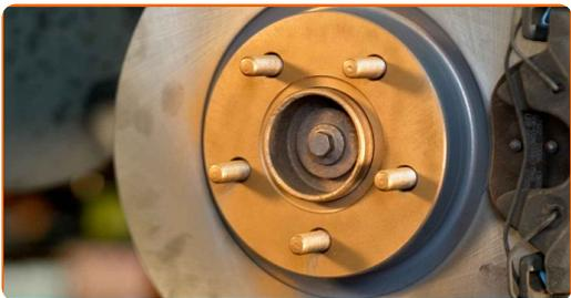
**61** Die Bremsscheibenoberfläche reinigen. Benutzen Sie einen Bremsenreiniger.
