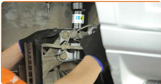
**56** Bauen Sie den Spurstangenkopf an dem Achsschenkel an.
