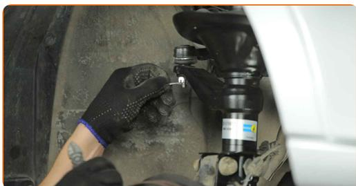
**59** Behandeln Sie die Federbein-Befestigungen. Behandeln Sie das Befestigungselement, das den Spurstangenkopf mit dem Achsschenkel verbindet. Benutzen Sie ein Kupferschmiermittel.
