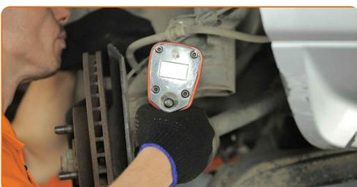
**16** Entfernen Sie die Befestigungsschrauben (2 Stück).
