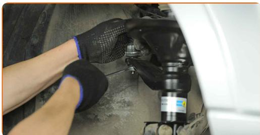
**58** Bringen Sie den Splint an. Verwenden Sie eine Kneifzange.
