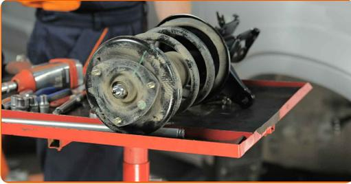
**42** Installieren Sie das Federbein am Radlauf.
