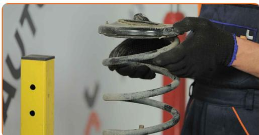
**31** Die Staubkappe des Stoßdämpfers und den Anschlagpuffer entfernen.
