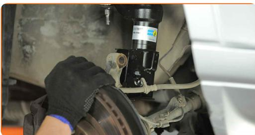
**50** Bringen Sie die Befestigungsschrauben an (2 Stück). Verwenden Sie einen Ratschenschlüssel.
