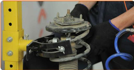
**38** Ziehen Sie die Federbeinkolbenstangenmutter an. Verwenden Sie Ring-Gabelschlüssel Nr. 17. Verwenden Sie Inbusschlüssel Nr. H7. Verwenden Sie einen Drehmomentschlüssel. Ziehen Sie ihn mit 44 Nm Drehmoment fest.
