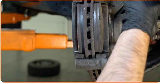
**Austausch: Bremsbeläge – Opel Corsa D. AUTODOC empfiehlt:**
