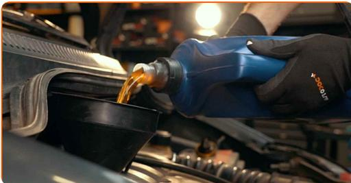
**Austausch: Motoröl und Ölfilter – DACIA Dokker Kombi (KE\_). Tipp von AUTODOC-Experten:**
