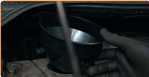
**20** Füllen Sie neues Öl in der vom Fahrzeughersteller empfohlenen Menge in den Motor ein.
