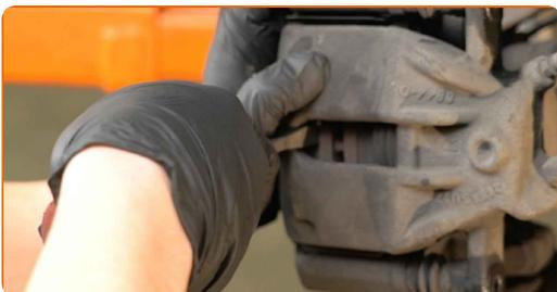
**12** Entfernen Sie den Bremssattel.
