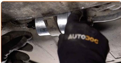
**11** Ziehen Sie die Befestigungsmittel des Treibstofffilters fest. Verwenden Sie einen Kreuzschlitzschraubendreher.
