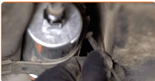
**12** Reinigen Sie die Befestigungen der Kraftstoff-Zuleitungen. Verwenden Sie Allzweckreinigungsspray.
