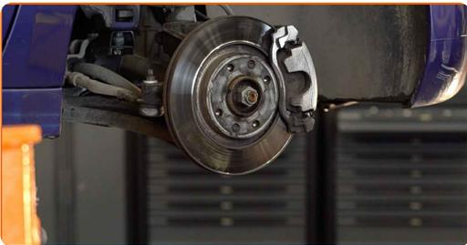
7 Reinigen Sie alle Verbindungen des Querlenkers. Benutzen Sie eine Drahtbürste. Benutzen Sie WD-40-Spray.
