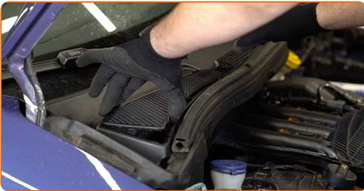
**4** Entfernen Sie die Kappe des Federbeinstützlagers.
