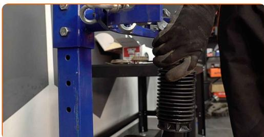
**44** Installieren Sie die Feder am Stoßdämpfer.
