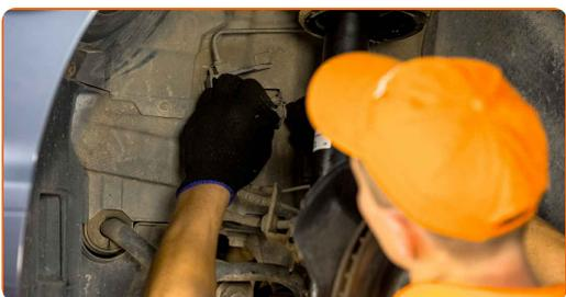
**53** Schließen Sie das Befestigungselement des ABS-Sensorkabels an die Stoßdämpferstrebe an.
