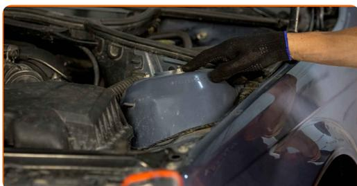
**24** Lösen Sie die obere Befestigung der Federbeinbefestigung. Verwenden Sie Stecknuss Nr. 13. Verwenden Sie einen Ratschenschlüssel.
