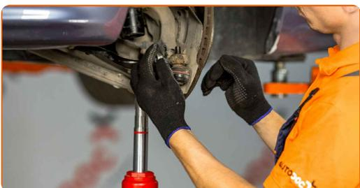
**52** Befestigen Sie den Bremsschlauch an der Strebe.
