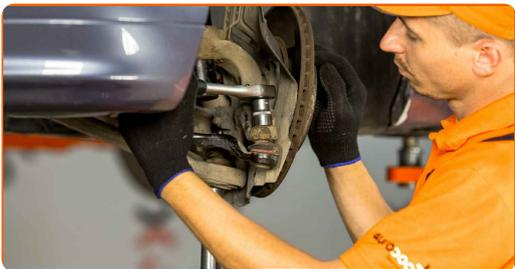
**51** Ziehen Sie die Befestigungsmutter an, die den Spurstangenkopf mit dem Achsschenkel verbindet. Verwenden Sie Stecknuss Nr. 18. Verwenden Sie einen Drehmomentschlüssel. Ziehen Sie ihn mit 65 Nm Drehmoment fest.
