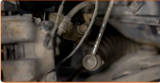
**17** Schrauben Sie den Bremsschlauch-Befestigungswinkel aus dem Federbein heraus. Verwenden Sie Stecknuss Nr. 18. Verwenden Sie einen Ratschenschlüssel.
