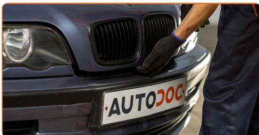
**22** Verwenden Sie eine Kotflügel-Schutzabdeckung, um Schäden an der Lackierung und den Kunststoffteilen des Autos zu verhindern.
