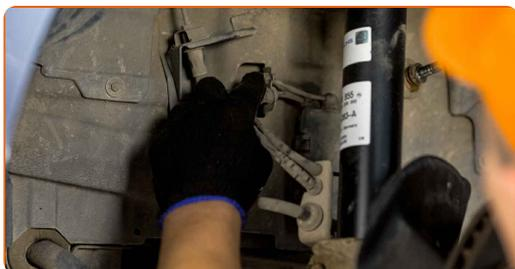
**16** Behandeln Sie den Haltebügel, der den Bremsschlauch und den Kabelbaum fixiert. Benutzen Sie WD-40-Spray.
