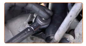
Entfernen Sie die Stütze unter dem Achsschenkel.
