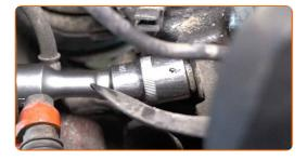
Entfernen Sie die Befestigungsschrauben.
