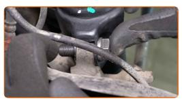
Ziehen Sie die unteren Befestigungen am Stoßdämpfer an. Verwenden Sie Stecknuss Nr. 19. Verwenden Sie einen Drehmomentschlüssel. Ziehen Sie ihn mit 110 Nm Drehmoment fest.
