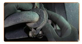
Ziehen Sie die Schraubbefestigungen an den Schellen der Stabilager fest. Verwenden Sie Ring-Gabelschlüssel Nr. 13. Verwenden Sie Stecknuss Nr. 13. Verwenden Sie einen Drehmomentschlüssel. Ziehen Sie ihn mit 20 Nm Drehmoment fest.
