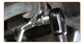
Entfernen Sie die Befestigungsschrauben.
