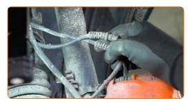
Lockern Sie die untere Befestigung am Stoßdämpfer. Verwenden Sie Stecknuss Nr. 19. Verwenden Sie einen Ratschenschlüssel.
