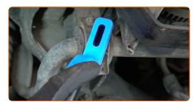
Schrauben Sie die Befestigungen der Stabilisatorbuchsenhalter heraus. Verwenden Sie Ring-Gabelschlüssel Nr. 13. Verwenden Sie Stecknuss Nr. 13. Verwenden Sie einen Ratschenschlüssel.
