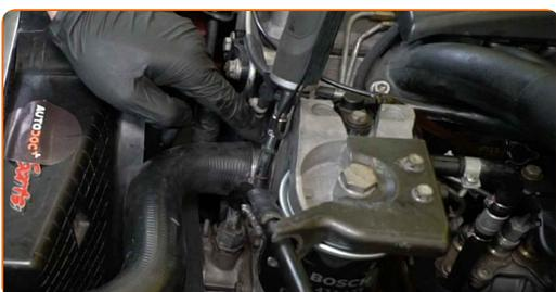
**47** Entfernen Sie den Deckel des Kühlmittelbehälters.
