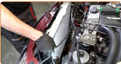
**32** Montieren Sie die oberen Klammern des Motorkühlers.
