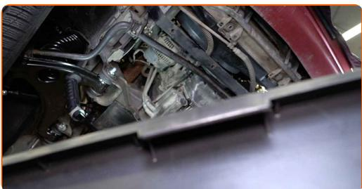
**6** Öffnen Sie den Ablasshahn des Kühlers. Verwenden Sie einen flachen Schraubendreher.
