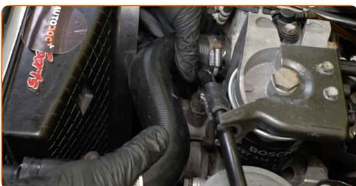
**46** Ziehen Sie die Schellen des oberen Kühlmittelschlauchs fest. Verwenden Sie Stecknuss Nr. 7. Verwenden Sie einen Ratschenschlüssel.
