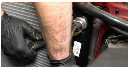
**35** Befestigen Sie die unteren Kühlmittelschläuche.
