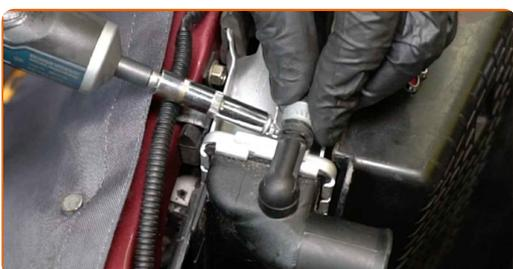
**45** Bringen Sie den oberen Kühlmittelschlauch an.
