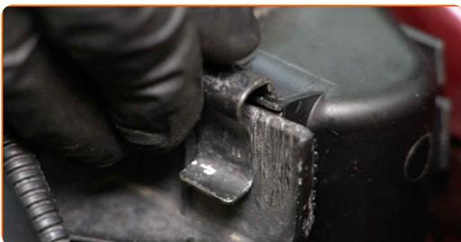
**43** Schließen Sie den Schlauch des Ausgleichsbehälters an den Kühler an.
