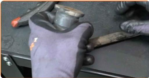
**12** Reinigen Sie die Montagesitze der Stabilisatorbuchsen. Benutzen Sie eine Drahtbürste. Verwenden Sie Allzweckreinigungsspray.
