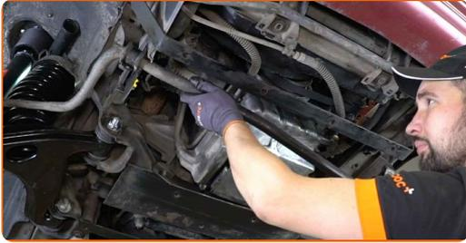
**11** Entfernen Sie die Stabilisatorbuchsen.
