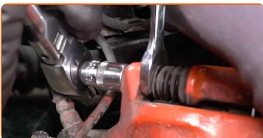
**11** Entfernen Sie die Befestigungsschrauben.
