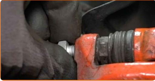
**22** Ziehen Sie die Bremssattelbefestigungen fest. Verwenden Sie Ring-Gabelschlüssel Nr. 15. Verwenden Sie Stecknuss Nr. 13. Verwenden Sie einen Drehmomentschlüssel. Ziehen Sie ihn mit 35 Nm Drehmoment fest.
