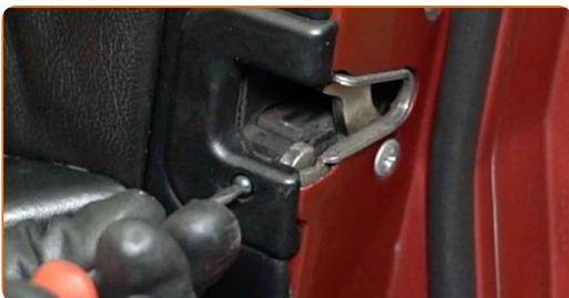
**36** Ziehen Sie die Befestigungen der Türverkleidung fest. Verwenden Sie Stecknuss Nr. 10. Verwenden Sie einen Drehmomentschlüssel. Ziehen Sie ihn mit 8 Nm Drehmoment fest.
