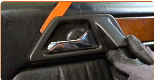
**5** Schrauben Sie die Befestigung der Türverkleidung ab. Verwenden Sie Stecknuss Nr. 10. Verwenden Sie einen Ratschenschlüssel.
