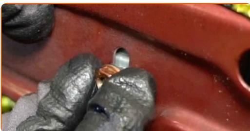
**23** Ziehen Sie die Befestigungselemente der Fensterheberbaugruppe fest. Verwenden Sie Stecknuss Nr. 10. Verwenden Sie einen Drehmomentschlüssel. Ziehen Sie ihn mit 8 Nm Drehmoment fest.
