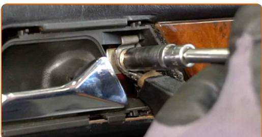
**6** Entfernen Sie die Abdeckung, die die Befestigungsschrauben der Außenspiegel verdeckt.
