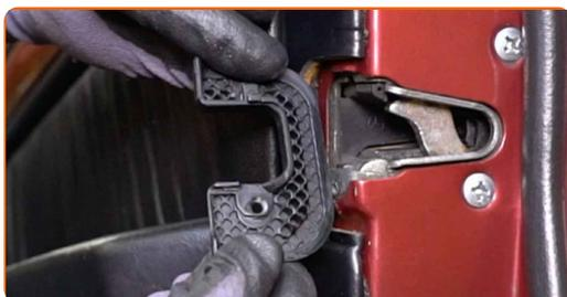
**4** Lösen Sie die Türgriffverkleidung. Verwenden Sie einen Zierleistenkeil.
