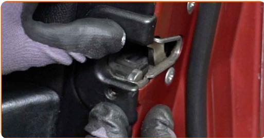
**35** Schrauben Sie die Befestigungsschraube der Abdeckung des Türschlosses ein. Verwenden Sie einen flachen Schraubendreher.
