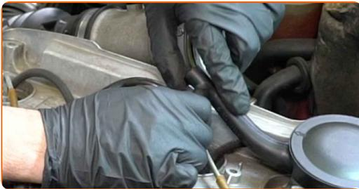
**19** Reinigen Sie die Befestigungen des Ansaugkrümmers. Verwenden Sie Allzweckreinigungsspray.
