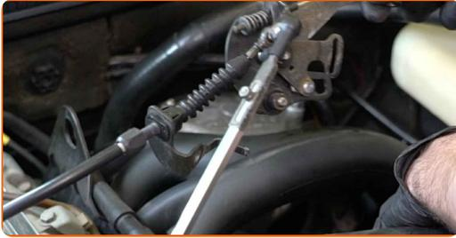
**18** Lösen Sie die Unterdruckschläuche vom Ansaugkrümmer.
