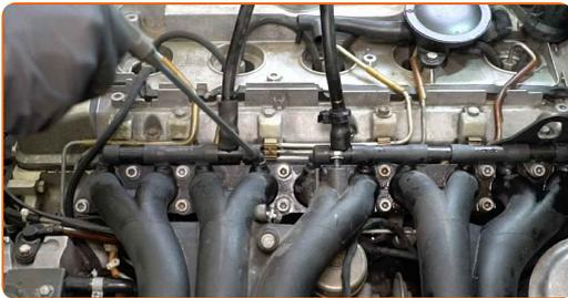
**20** Schrauben Sie die Ansaugkrümmer Befestigungen ab. Verwenden Sie den Torx T45. Verwenden Sie einen Ratschenschlüssel.
