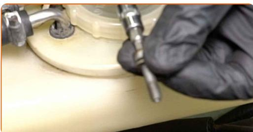
**7** Entfernen Sie das Einlassrohr. Benutzen Sie ein Brecheisen.
