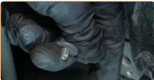
**5** Schrauben Sie die Schraubbefestigungen ab, die das Einlassrohr mit dem Ansaugkrümmer verbinden. Verwenden Sie Inbusschlüssel Nr. H5. Verwenden Sie einen Ratschenschlüssel.
