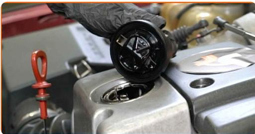
5 Reinigen Sie den Deckel des Ölfilter-Gehäuses. Verwenden Sie Allzweckreinigungsspray.
