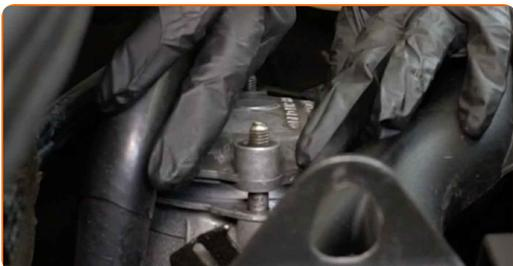
**25** Ziehen Sie die Schraubbefestigungen des Ölfilterdeckels fest. Verwenden Sie Stecknuss Nr. 13. Verwenden Sie einen Drehmomentschlüssel. Ziehen Sie ihn mit 25 Nm Drehmoment fest.
