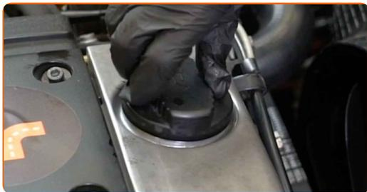
**31** Befestigen Sie den Deckel des Öleinfüllstutzens.
