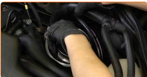
**24** Montieren Sie den Ölfilterdeckel.
