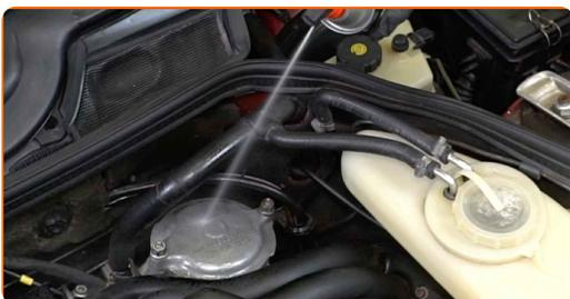
6 Schrauben Sie die Schraubbefestigungen des Ölfilterdeckels ab. Verwenden Sie Stecknuss Nr. 13. Verwenden Sie einen Ratschenschlüssel.
