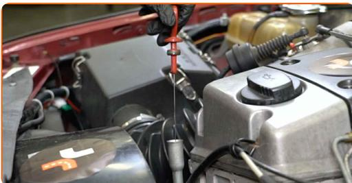
4 Schrauben Sie die Öleinfüllschraube ab.
