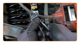
Reinigen Sie den Montagesitz des Bremsschlauchs auf dem Bremssattel. Benutzen Sie eine Drahtbürste. Benutzen Sie WD-40-Spray.
