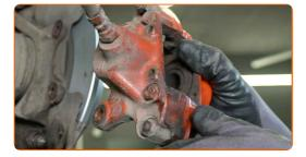
Schrauben Sie den Bremsschlauch vom Bremssattel ab.
