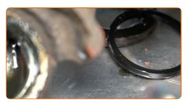
Entfernen Sie die Staubmanschetten der Bremssattelkolben. Verwenden Sie einen flachen Schraubendreher.
