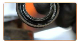
Entfernen Sie den Bremssattelkolben. Verwenden Sie eine Wasserpumpenzange.
