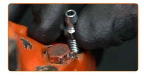
Reinigen Sie den Bereich, in dem der Bremsschlauch mit dem Bremssattel verbunden ist. Benutzen Sie eine Drahtbürste. Verwenden Sie Allzweckreinigungsspray.
