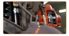
51 Entlüften Sie die Bremsanlage.
