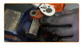
Ziehen Sie die Bremsentlüftungsschraube an.
