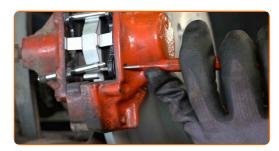
10 Entfernen Sie die Rückholfeder der Bremsbeläge.
