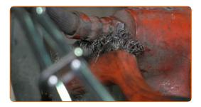
Lockern Sie die Befestigung des Bremsschlauchs. Verwenden Sie Ring-Gabelschlüssel Nr. 14.
