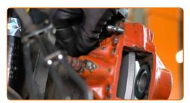
Ziehen Sie die Bremssattelbefestigungen fest. Verwenden Sie Stecknuss Nr. 17. Verwenden Sie einen Drehmomentschlüssel. Ziehen Sie ihn mit 65 Nm Drehmoment fest.
