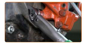
Ziehen Sie das Befestigungselement an, das die Bremsleitung mit dem Bremssattel verbindet. Verwenden Sie Ring-Gabelschlüssel Nr. 14. Verwenden Sie einen Drehmomentschlüssel. Ziehen Sie ihn mit 18 Nm Drehmoment fest.
