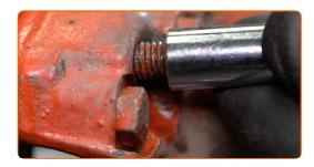
Schrauben Sie die Befestigungsschrauben ab, die die beiden Teile des Bremssattels verbinden. Verwenden Sie Stecknuss Nr. 14. Verwenden Sie einen Ratschenschlüssel.
