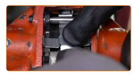
Montieren Sie die Führungsbolzen der Bremsbeläge. Verwenden Sie einen Splintentreiber. Benutzen Sie einen Hammer.
