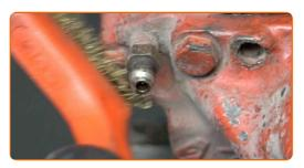
Lösen Sie die Bremsentlüftungsschraube. Verwenden Sie Stecknuss Nr. 9. Verwenden Sie einen Ratschenschlüssel.
