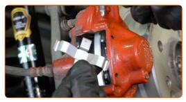
Verteilen Sie die Bremsbeläge. Benutzen Sie ein Brecheisen (2 Teile).
