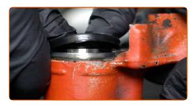
Setzen Sie Sicherungsringe für Staubmanschetten ein.
