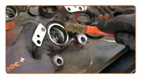
Setzen Sie neue O-Ringe für den Bremssattelkolben ein.
