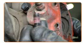
Entfernen Sie den Bremssattel.
