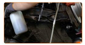
50 Entfernen Sie die Bremsschlauchklemmen.
