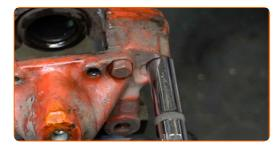
Entfernen Sie die Befestigungsschrauben.
