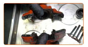
Entfernen Sie die O-Ringe. Verwenden Sie einen flachen Schraubendreher.
