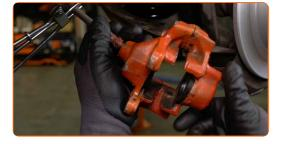
Bauen Sie den Bremssattel ein und befestigen Sie diesen.
