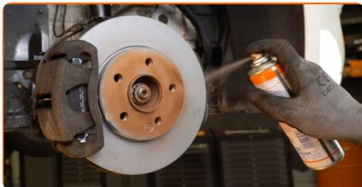
**14** Die Bremsscheibenoberfläche reinigen. Benutzen Sie einen Bremsenreiniger.
