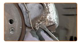
Lösen Sie den Bremsbelagverschleißsensor. Verwenden Sie eine Spitzzange.
