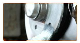
Die Bremsscheibenoberfläche reinigen. Benutzen Sie einen Bremsenreiniger.
