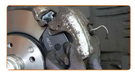
Ziehen Sie die Bremssattelbefestigungen fest. Verwenden Sie Inbusschlüssel Nr. H7. Verwenden Sie einen Drehmomentschlüssel. Ziehen Sie ihn mit 25 Nm Drehmoment fest.
