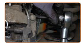
Setzen Sie die Kappen auf die Führungsbolzenmanschetten des Bremssattels.
