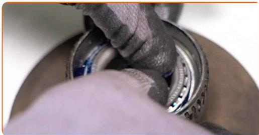
**30** Bauen Sie den Radlagerdichtring ein. Verwenden Sie einen Druckstücksatz mit Ein-/Auspresswerkzeug.
