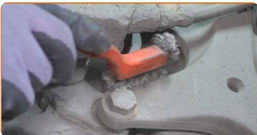
**10** Schrauben Sie die Befestigungen des Bremssattelhalters ab. Verwenden Sie Stecknuss Nr. 18. Verwenden Sie einen Ratschenschlüssel.
