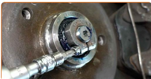
**48** Bauen Sie die Schutzkappe des Nabenlagers ein. Verwenden Sie einen Druckstücksatz mit Ein-/Auspresswerkzeug.
