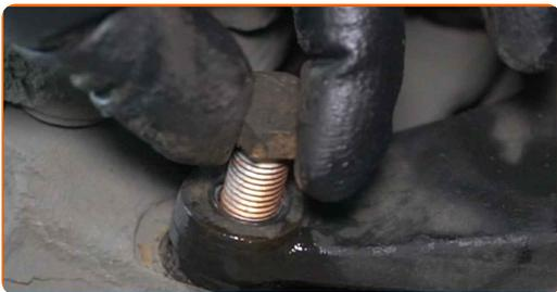
**40** Ziehen Sie die Befestigungen des Bremssattelhalters fest. Verwenden Sie Stecknuss Nr. 18. Verwenden Sie einen Drehmomentschlüssel. Ziehen Sie ihn mit 115 Nm Drehmoment fest.
