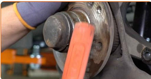
**18** Entfernen Sie die Schutzkappe des Nabenlagers. Benutzen Sie ein Brecheisen.
