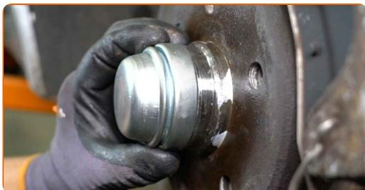
**49** Reinigen Sie die Oberfläche an welcher die Felge montiert werden soll. Benutzen Sie eine Drahtbürste.
