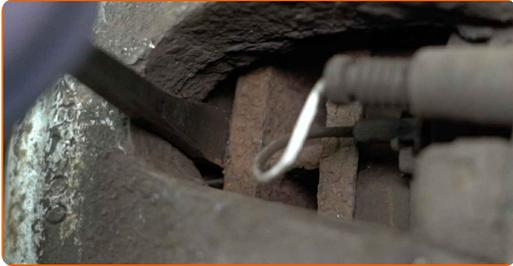
**9** Die Befestigungselemente der Bremssattelhalterung reinigen. Benutzen Sie eine Drahtbürste. Benutzen Sie WD-40-Spray.
