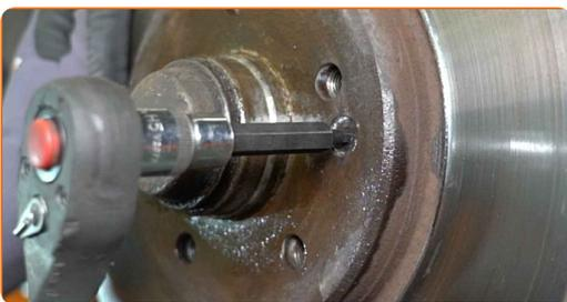
**15** Entfernen Sie die Befestigungsschraube.
