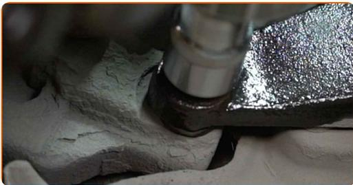
**11** Entfernen Sie die Befestigungsschrauben.
