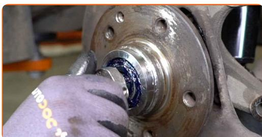
**34** Behandeln Sie die Radnabe an der Kontaktstelle mit der Bremsscheibe. Verwenden Sie Keramikfett.
