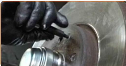
**37** Schrauben Sie die Befestigungen der Bremsscheibe fest. Verwenden Sie Inbusschlüssel Nr. H5. Verwenden Sie einen Drehmomentschlüssel. Ziehen Sie ihn mit 10 Nm Drehmoment fest.
