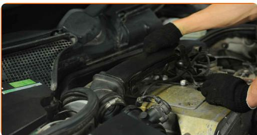
**28** Verbinden Sie das Luftansaugrohr mit dem Luftfilter-Gehäuse.
