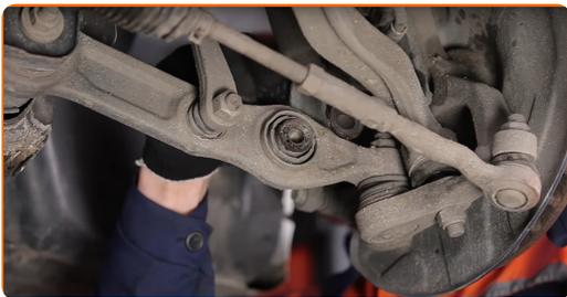
**10** Reinigen Sie die Befestigungen der Koppelstange. Benutzen Sie eine Drahtbürste. Benutzen Sie WD-40-Spray.
