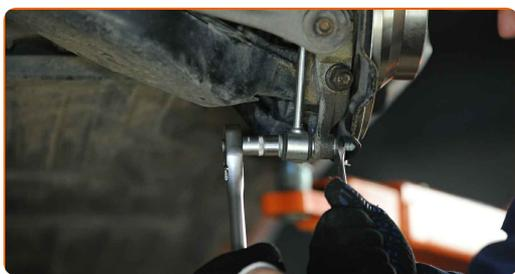
**15** Ziehen Sie das Befestigungselement an, das die Druckstange mit dem Stabilisator verbindet. Verwenden Sie Ring-Gabelschlüssel Nr. 16. Verwenden Sie Ring-Gabelschlüssel Nr. 22. Verwenden Sie einen Drehmomentschlüssel. Ziehen Sie ihn mit 50 Nm Drehmoment fest.
