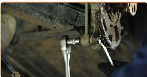
**25** Entfernen Sie die Befestigungsschraube.
