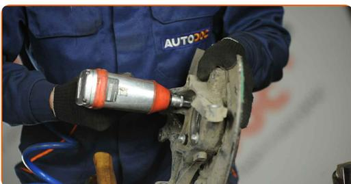
**49** Behandeln Sie die Befestigungen des Radnabenlagers. Benutzen Sie ein Kupferschmiermittel.
