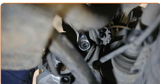
**8** Entfernen Sie die Befestigungsschrauben (2 Stück).
