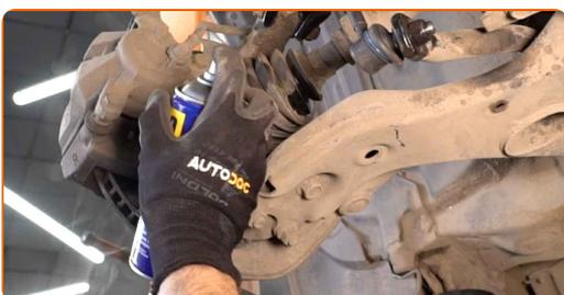
**7** Lösen Sie die Befestigung der Sattelhalterung. Verwenden Sie Ring-Gabelschlüssel Nr. 18. Verwenden Sie Stecknuss Nr. 18. Verwenden Sie einen Ratschenschlüssel.
