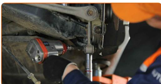
**71** Entfernen Sie den Träger unter dem Achsschenkel.
