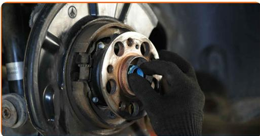
**82** Ziehen Sie die Nabe hindurch. Verwenden Sie Stecknuss Nr. 32. Verwenden Sie einen Drehmomentschlüssel. Ziehen Sie ihn mit 170 Nm Drehmoment fest.+45°
