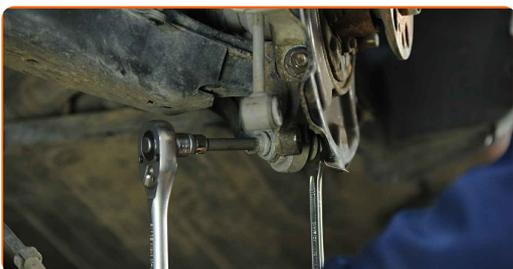
**28** Entfernen Sie die Befestigungsschraube. Verwenden Sie den Torx M12. Verwenden Sie einen Ratschenschlüssel.
