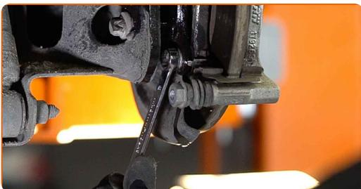
**13** Entfernen Sie die Sattelhalterung.
