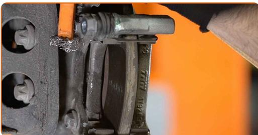
**12** Lösen Sie die Befestigung der Sattelhalterung. Verwenden Sie Ring-Gabelschlüssel Nr. 13.
