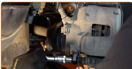
**11** Entfernen Sie den Bremssattel.
