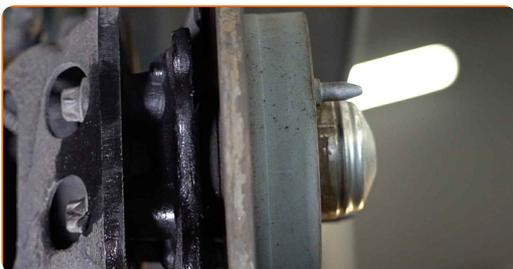
**14** Die Bremsscheibenoberfläche reinigen. Benutzen Sie eine Drahtbürste. Benutzen Sie WD-40-Spray.
