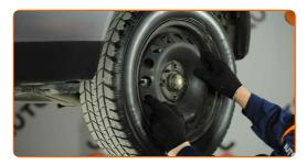
6.1 Schrauben Sie die Bremstrommel-Befestigung ab.
