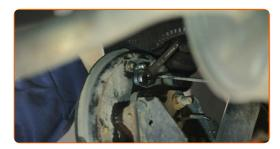
Entlüften Sie das Bremszylindersystem. Verwenden Sie Ring-Gabelschlüssel Nr. 8.
