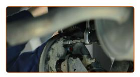
Verbinden Sie die Hydraulikleitung mit der Hinterseite des Radzylinders. Verwenden Sie einen offenen Ringschlüssel #11.
