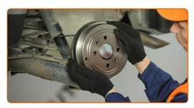
Ziehen Sie die Halteklammern der Bremstrommeln an. Verwenden Sie Stecknuss Nr. 12. Verwenden Sie einen Drehmomentschlüssel. Ziehen Sie ihn mit 15 Nm Drehmoment fest.
