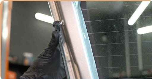
**Austausch: Heckklappendämpfer – FIAT PUNTO EVO (199). Tipp von AUTODOC:**
