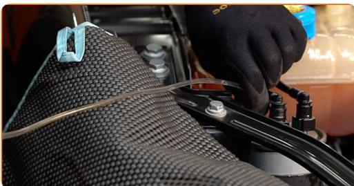
**16** Schrauben Sie die Kraftstofffilter-Entlüftungsschraube ein. Verwenden Sie Stecknuss Nr. 12. Verwenden Sie einen Ratschenschlüssel.
