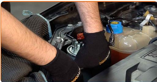
**10** Ziehen Sie die Befestigungsmittel des Treibstofffilters fest. Verwenden Sie Stecknuss Nr. 10. Verwenden Sie einen Ratschenschlüssel.
