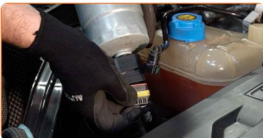
**9** Installieren Sie einen neuen Kraftstofffilter.
