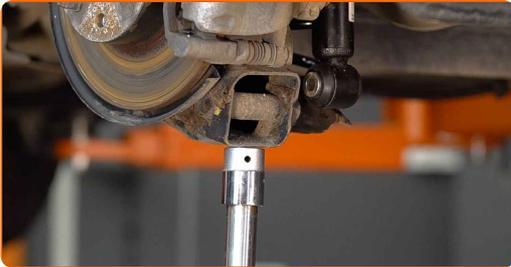
**14** Den Stoßdämpfer entfernen.
