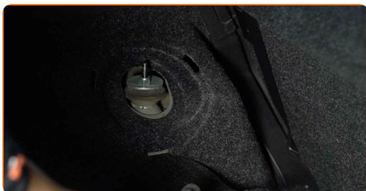
**3** Drehen Sie das obere Befestigungselement des Stoßdämpfers auf. Verwenden Sie Ring-Gabelschlüssel Nr. 17. Verwenden Sie eine Gripzange.
