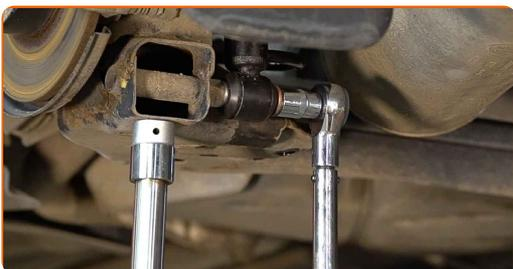
**22** Die Montage unter dem Hinterachsträger entfernen.
