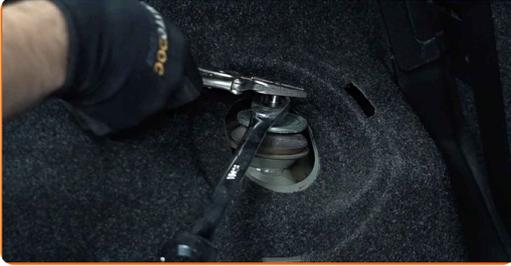
**13** Entfernen Sie die Befestigungsschraube. Verwenden Sie Stecknuss Nr. 19.
