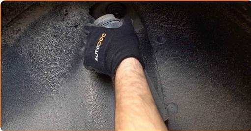
**15** Die Staubkappe des Stoßdämpfers und den Anschlagpuffer entfernen.
