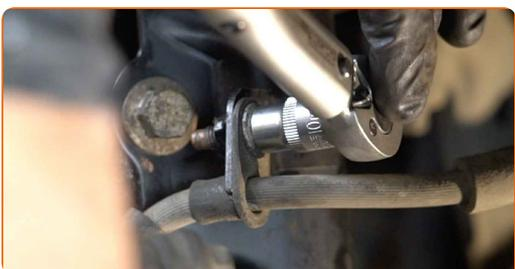
**51** Verbinden Sie das ABS mit der Sensorverdrahtung.
