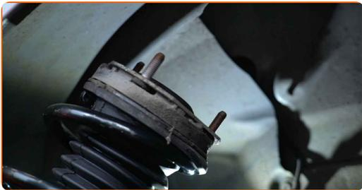
**42** Schrauben Sie die obere Befestigung des Domlagers an. Schrauben Sie diese nicht fest.
