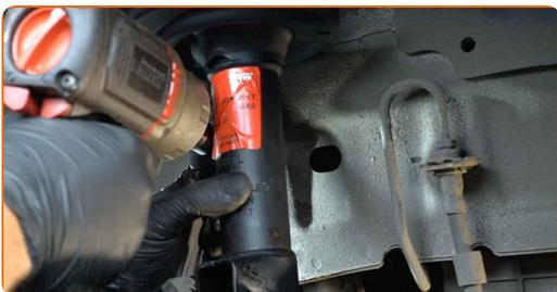
**54** Ziehen Sie das Befestigungselement an, das die Druckstange mit dem Federbein verbindet. Verwenden Sie Stecknuss Nr. 15. Verwenden Sie einen Drehmomentschlüssel. Ziehen Sie ihn mit 48 Nm Drehmoment fest.
