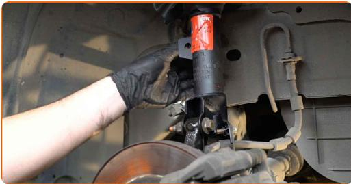
**53** Ziehen Sie die Befestigungselemente des Stabilenkers fest. Verwenden Sie Stecknuss Nr. 15. Verwenden Sie einen Ratschenschlüssel.
