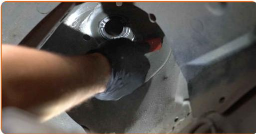
**41** Installieren Sie das Federbein am Radlauf.
