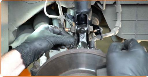
**52** Montieren Sie den Querlenker.
