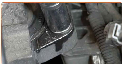
**7** Reinigen Sie die Motorlager-Befestigungen. Benutzen Sie eine Drahtbürste. Benutzen Sie WD-40-Spray.
