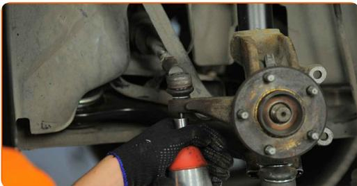
**23** Ziehen Sie den Spurstangenkopf vom Achsschenkel. Verwenden Sie einen Kugelgelenkabzieher.
