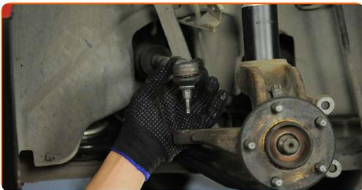
**24** Reinigen Sie das Verbindungselement, welches das Kugelgelenk mit dem Achsschenkel verbindet. Benutzen Sie eine Drahtbürste. Benutzen Sie WD-40-Spray.
