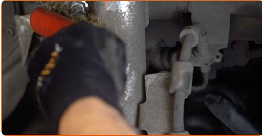
**9** Schrauben Sie das Befestigungselement heraus, das die Druckstange mit dem Federbein verbindet. Verwenden Sie Ring-Gabelschlüssel Nr. 17. Verwenden Sie Inbusschlüssel Nr. H5. Verwenden Sie einen Ratschenschlüssel.
