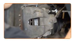
Installieren Sie die Staubschutzkappen der Bremssattel-Führungsstifte.
