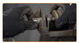
Bremssattelhalter, Bremssattelführungsstifte und Manschetten prüfen. Säubern Sie diese. Bei Bedarf ersetzen. Benutzen Sie eine Drahtbürste. Benutzen Sie einen Bremsenreiniger.
