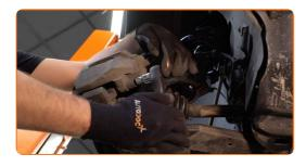
Entfernen Sie den Bremssattel.
