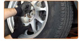
Senken Sie das Auto und ziehen Sie die Radschrauben über Kreuz an. Verwenden Sie einen Drehmomentschlüssel. Ziehen Sie ihn mit 110 Nm Drehmoment fest.
