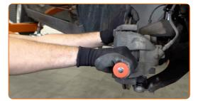
Lösen Sie die Bremssattel-Haltefeder. Benutzen Sie ein Brecheisen.
