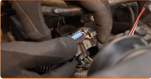
**5** Setzen Sie Markierungen, um die Anschlussreihenfolge der Zündkerzenkabel zu kennzeichnen.
