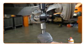
Die Montage unter dem Hinterachsträger entfernen.
