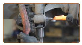
Schrauben Sie den unteren Befestiger des Stoßdämpfers ab. Verwenden Sie Stecknuss Nr. 15. Verwenden Sie einen Ratschenschlüssel.
