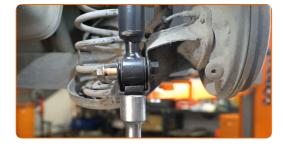
Schrauben Sie das untere Befestigungselement des Stoßdämpfers ein. Verwenden Sie Stecknuss Nr. 15. Verwenden Sie einen Ratschenschlüssel.
