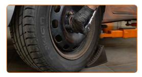
Entfernen Sie den Wagenheber sowie die Unterlegkeile. 41
