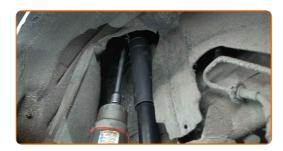
Ziehen Sie die obere Stoßdämpferbefestigung an. Verwenden Sie Stecknuss Nr. 10. Verwenden Sie einen Drehmomentschlüssel. Ziehen Sie ihn mit 25 Nm Drehmoment fest.
