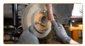
Behandeln Sie die Oberfläche, an der die Radfelge die Bremstrommel berührt. Benutzen Sie ein Kupferschmiermittel.
