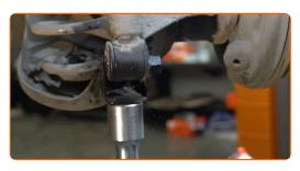
Den Stoßdämpfer entfernen.
