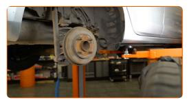
Schrauben Sie die Verbindungselemente der Radkastenabdeckung ab. Verwenden Sie Stecknuss Nr. 10. Verwenden Sie einen Ratschenschlüssel.
