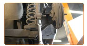
Schrauben Sie das obere Befestigungselement des Stoßdämpfers ab. Verwenden Sie Stecknuss Nr. 10. Verwenden Sie einen Ratschenschlüssel.
