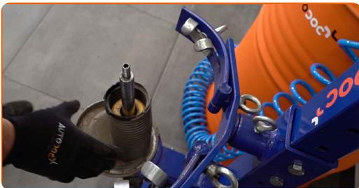
**33** Installieren Sie die Feder am Stoßdämpfer.
