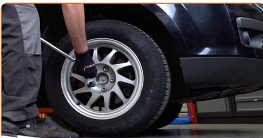
**14** Heben Sie die Vorderseite des Autos und sichern auf Stützen.
