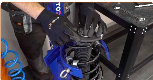
**36** Ziehen Sie die Federbeinkolbenstangenmutter an. Verwenden Sie den Torx T30. Verwenden Sie Ringgabelschlüssel Nr. 19. Verwenden Sie einen Drehmomentschlüssel. Ziehen Sie ihn mit 50 Nm Drehmoment fest.
