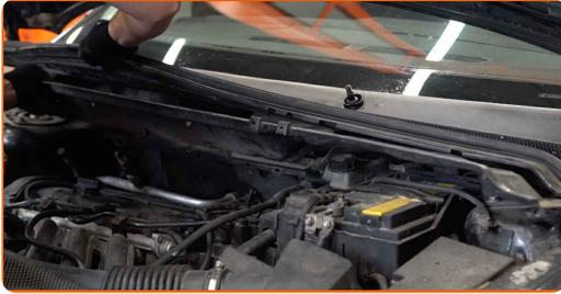
**11** Lösen Sie die obere Befestigung des Domlagers. Verwenden Sie Stecknuss Nr. 13. Verwenden Sie einen Ratschenschlüssel.
