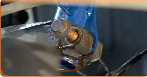
**55** Schrauben Sie das Befestigungselement ein, das das Federbein mit dem Achsschenkel verbindet. Verwenden Sie Stecknuss Nr. 15. Verwenden Sie einen Ratschenschlüssel.
