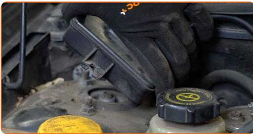
**4** Reinigen Sie die Befestigungselemente des Stoßdämpferdomlagers. Benutzen Sie eine Drahtbürste. Benutzen Sie WD-40-Spray.
