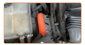
Schrauben Sie das obere Befestigungselement des Motorlagers heraus. Verwenden Sie Stecknuss Nr. 16. Verwenden Sie einen Ratschenschlüssel.
