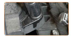
Reinigen Sie die Motorlager-Befestigungen. Benutzen Sie eine Drahtbürste. Benutzen Sie WD-40-Spray.
