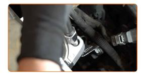
Schrauben Sie die Befestigungen, die das Motorlager mit der Karosserie verbinden, fest. Verwenden Sie Stecknuss Nr. 18. Verwenden Sie einen Drehmomentschlüssel. Ziehen Sie ihn mit 65 Nm Drehmoment fest.
