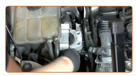
Ziehen Sie die Befestigungsschrauben des Motorlagers an. Verwenden Sie Stecknuss Nr. E11. Verwenden Sie einen Drehmomentschlüssel. Ziehen Sie ihn mit 32 Nm Drehmoment fest.
