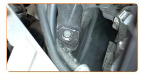
Schrauben Sie die Befestigungen, die das Motorlager mit der Karosserie verbinden, ab. Verwenden Sie Stecknuss Nr. 18. Verwenden Sie einen Ratschenschlüssel.
