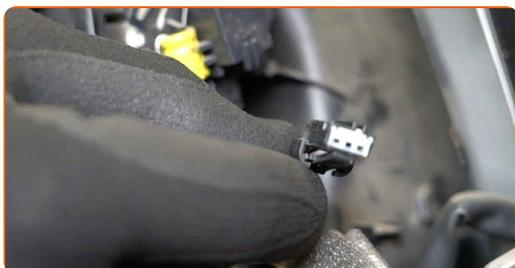
**8** Entfernen Sie den Steckverbinder des Spiegelverstellungsschalters von der Tür.
