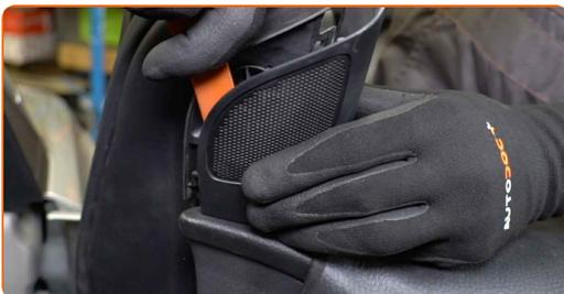
**5** Schrauben Sie die Befestigungen der Schutzabdeckung des Außenspiegels ab. Verwenden Sie den Torx T25.
