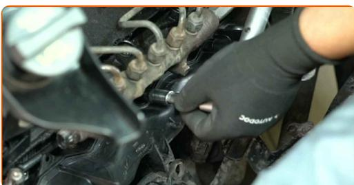
**52** Befestigen Sie den Ansaugschlauch am Ansaugkrümmer.
