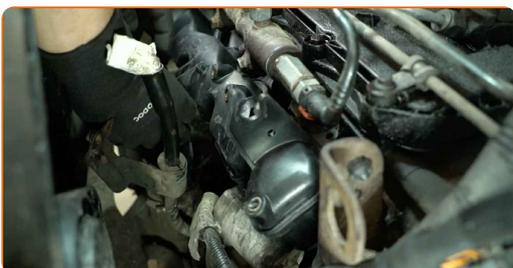
**51** Ziehen Sie die Befestigungsschrauben des Ansaugkrümmers fest. Verwenden Sie eine Stecknuss mit einem Durchmesser von 10 mm. Verwenden Sie einen Drehmomentschlüssel. Anzugsdrehmoment: 25 N·m.
