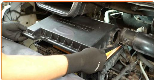
**7** Stopfen Sie den Ansaugschlauch mit einem Mikrofaser Tuch zu, um zu vermeiden, dass Staub und Schmutz in das Luftfiltersystem gelangen.
