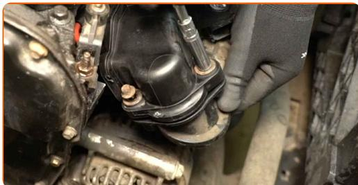
**54** Schrauben Sie die Befestigungsschrauben ein, die den Ansaugschlauch mit dem Ansaugkrümmer verbinden. Verwenden Sie eine Stecknuss mit einem Durchmesser von 13 mm. Verwenden Sie eine Stecknuss mit einem Durchmesser von 8 mm. Verwenden Sie einen Ratschenschlüssel. Verwenden Sie eine Kardangelenke-Steckschlüsselverlängerung.
