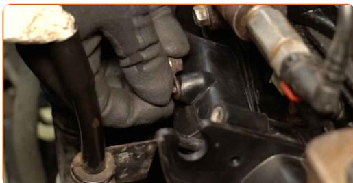
**56** Schrauben Sie die Befestigungsschrauben der Halterung des Ölmesstabs ein. Verwenden Sie eine Stecknuss mit einem Durchmesser von 8 mm. Verwenden Sie einen Ratschenschlüssel.
