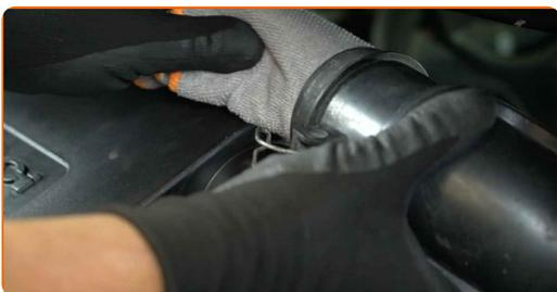
**74** Verbinden Sie den Ansaugschlauch mit dem Luftfiltergehäuse.
