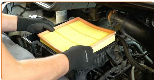
**71** Setzen Sie die Luftfilterabdeckung ein.
