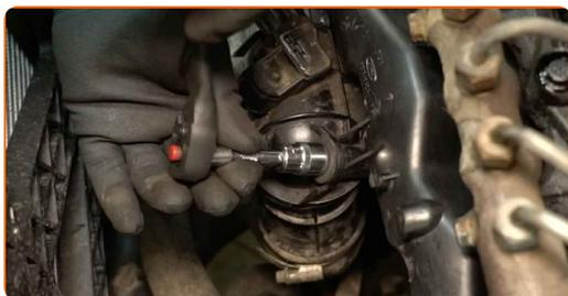
**55** Bringen Sie die Befestigungsschrauben der Halterung des Ölmesstabs an.
