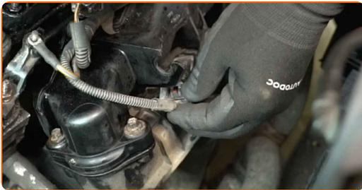
**64** Befestigen Sie das Stromkabel der Glühkerzen und schrauben Sie die Mutter auf, mit der es gesichert ist. Verwenden Sie eine Stecknuss mit einem Durchmesser von 8 mm. Verwenden Sie einen Ratschenschlüssel.
