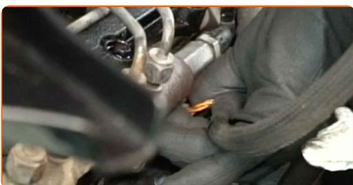
**62** Schließen Sie den Stecker des Kraftstoffdrucksensors an.
