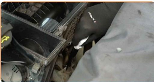
**14** Entfernen Sie das Luftfiltergehäuse.
