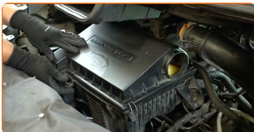
**72** Lassen Sie die Halteklammern der Luftfilterabdeckung einrasten.
