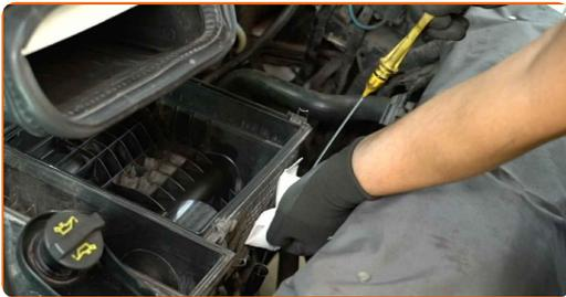
**13** Verschließen Sie das Loch für den Ölmesstab mit einem Papiertuch, um zu verhindern, dass Schmutz in das System gelangt.
