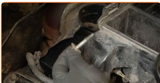
**11** Lösen Sie die Gummischläuche vom Luftfiltergehäuse.
