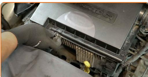
**6** Entfernen Sie die Luftfilterabdeckung.
