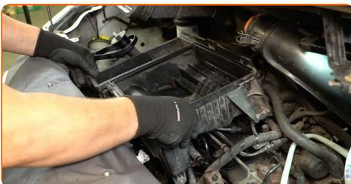
**67** Befestigen Sie die Gummischläuche am Luftfiltergehäuse.
