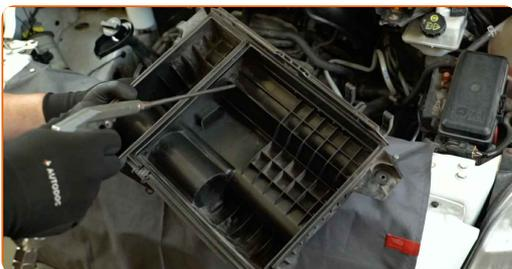
**66** Setzen Sie das Luftfiltergehäuse ein.
