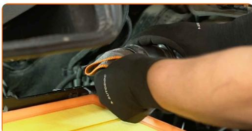
**8** Entfernen Sie den Filtereinsatz aus dem Filtergehäuse.
