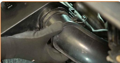
**5** Lösen Sie die Halteklammern der Luftfilterabdeckung.
