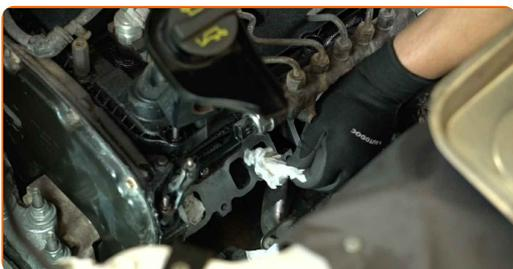
**49** Entfernen Sie das Papiertuch aus dem Ansaugschlauch.
