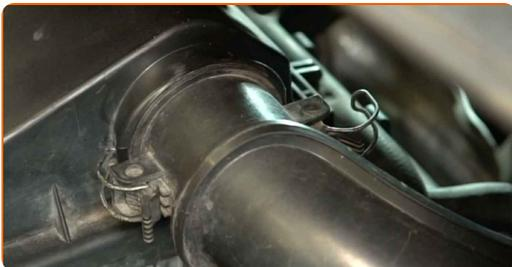
**4** Trennen Sie den Ansaugschlauch vom Luftfiltergehäuse.
