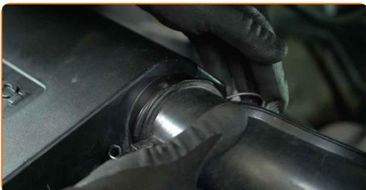
**75** Lassen Sie die Halteklammern des Ansaugschlauchs einrasten.
