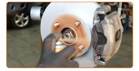
Die Bremsscheibenoberfläche reinigen. Benutzen Sie einen Bremsenreiniger.
