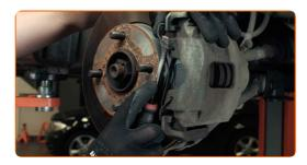
Entfernen Sie den Bremssattel.
