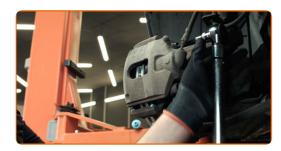
Installieren Sie die Staubschutzkappen der Bremssattel-Führungsstifte.
