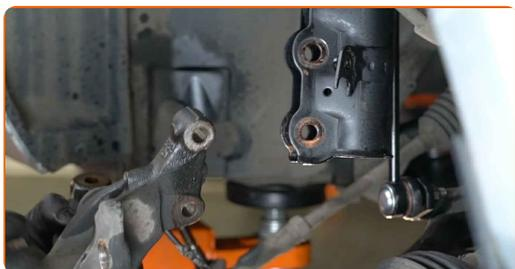
**32** Entfernen Sie die Achsschenkel zusammen mit der Nabe.
