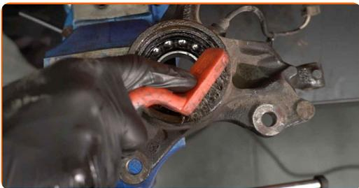
**40** Drücken Sie das Radnabenlager heraus. Verwenden Sie einen Druckstücksatz mit Ein-/Auspresswerkzeug.
