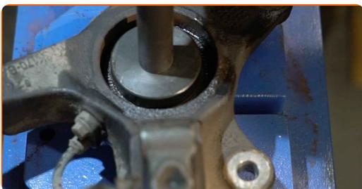
**41** Reinigen Sie den Einbauort für die Nabenlagerung. Benutzen Sie eine Drahtbürste. Benutzen Sie WD-40-Spray.
