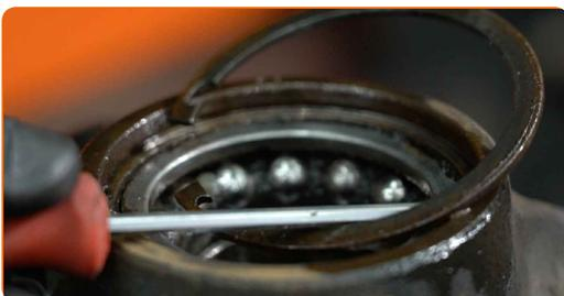
**39** Reinigen Sie den Einbauort für die Nabenlagerung. Benutzen Sie eine Drahtbürste. Benutzen Sie WD-40-Spray.
