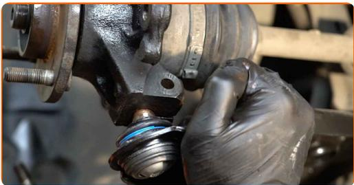
**54** Reinigen Sie die Montagesitze des Spurstangenkopfes. Benutzen Sie eine Drahtbürste. Benutzen Sie WD-40-Spray.
