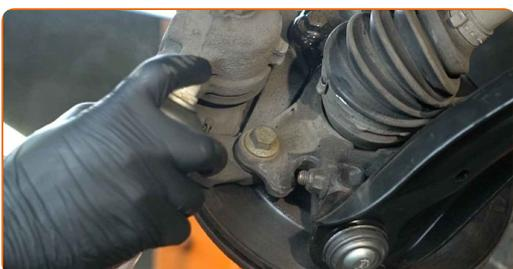
**12** Lösen Sie die Befestigung der Sattelhalterung. Verwenden Sie Stecknuss Nr. 15. Verwenden Sie ein Windeisen.
