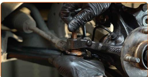
**56** Schrauben Sie die Befestigungsmutter auf, die den Spurstangenkopf mit dem Achsschenkel verbindet. Verwenden Sie Stecknuss Nr. 18. Verwenden Sie einen Ratschenschlüssel.
