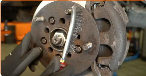
**37** Reinigen und schmieren Sie die Oberfläche der Radnabe, die die Felge berührt. Verwenden Sie Keramikfett.
