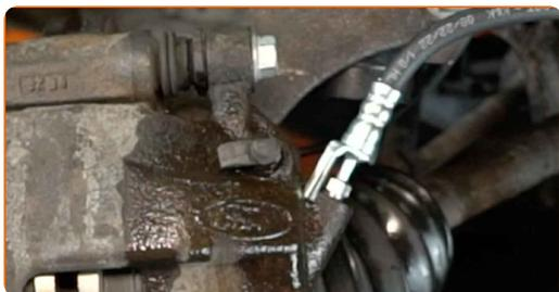
**35** Bringen Sie die Schutzkappe der Bremsenentlüftungsschraube wieder an.
