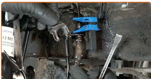
**16** Entfernen Sie den Bremsschlauch.
