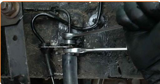
**25** Ziehen Sie die Überwurfmutter der Bremsleitung am Bremssattel fest. Verwenden Sie einen offenen Ringschlüssel mit einem Durchmesser von 11 mm. Verwenden Sie einen Einspritzleitungsschlüssel mit einem Durchmesser von 11 mm. Verwenden Sie einen Drehmomentschlüssel. Anzugsdrehmoment: 15 N·m.
