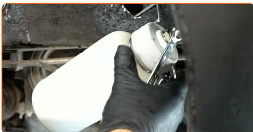
**33** Ziehen Sie die Bremsenentlüftungsschraube fest. Verwenden Sie eine Stecknuss mit einem Durchmesser von 11 mm. Verwenden Sie einen Drehmomentschlüssel. Anzugsdrehmoment: 9 N·m.
