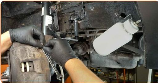
**29** Lockern Sie die Bremsenentlüftungsschraube. Verwenden Sie einen Ringmaulschlüssel mit einem Durchmesser von 11 mm.
