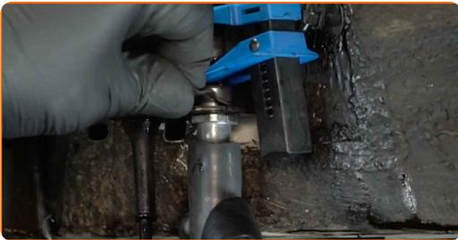
**23** Entfernen Sie die Klemme für den Leitungsverschluss von der Bremsleitung.
