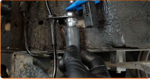
**22** Bringen Sie die Halteklammer für den Bremsschlauch an. Verwenden Sie einen Hammer.
