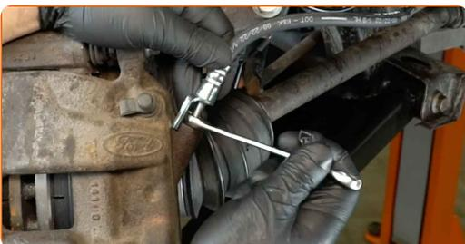
**26** Entfernen Sie die Schutzkappe der Bremsenentlüftungsschraube.
