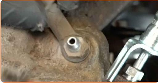
**27** Reinigen Sie die Entlüftungsschraube. Benutzen Sie eine Drahtbürste. Verwenden Sie einen Bremsenreiniger.
