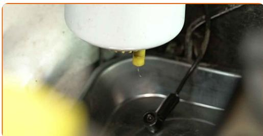
**6** Drehen Sie den Filter um eine Vierteldrehung gegen den Uhrzeigersinn und bauen Sie ihn dann aus.
