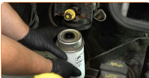
**7** Setzen Sie den neuen Filter ein und befestigen Sie ihn in seiner Aufnahme.
