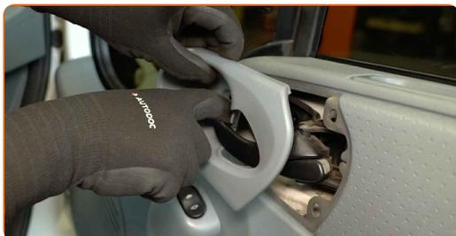
**4** Entfernen Sie die Befestigungsschrauben.
