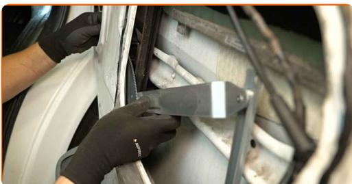
**21** Setzen Sie die Befestigungsbolzen ein.
