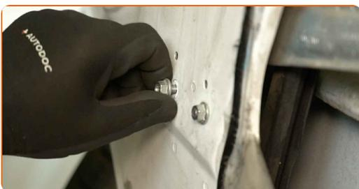
**19** Entfernen Sie den Fensterhebermechanismus.
