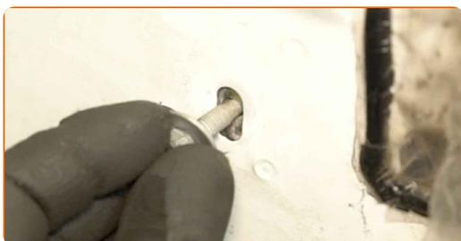
**25** Ziehen Sie die Befestigungsschraube der Fensterführungsschiene fest. Verwenden Sie eine Stecknuss mit einem Durchmesser von 8 mm. Verwenden Sie einen Drehmomentschlüssel. Anzugsdrehmoment: 6 N·m.
