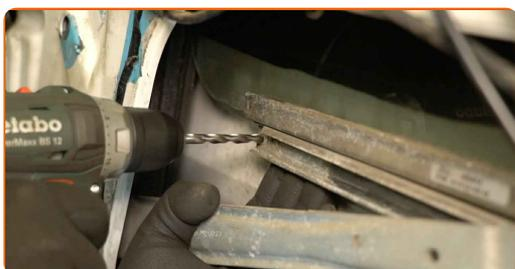
**14** Bohren Sie die Niete heraus, die den Fensterhebermechanismus mit der Tür verbinden. Verwenden Sie eine Bohrmaschine. Verwenden Sie ein Bohrer-Set.
