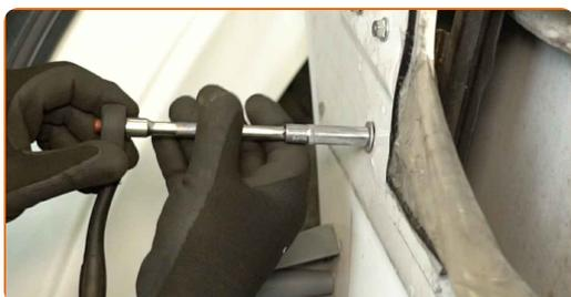
**16** Entfernen Sie die Befestigungsschraube.
