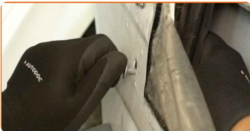
**17** Schrauben Sie die Befestigungsmuttern des Fensterhebermechanismus ab. Verwenden Sie eine Stecknuss mit einem Durchmesser von 10 mm. Verwenden Sie einen Ratschenschlüssel.
