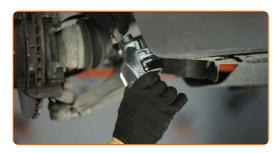
Reinigen Sie die Bremssattel-Führungsstifte.
