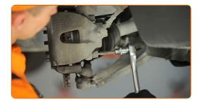
Entfernen Sie die Führungsstifte aus dem Bremssattel.
