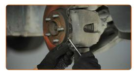
Entfernen Sie die Staubschutzkappen der Bremssattel-Führungsstifte. Verwenden Sie einen flachen Schraubendreher.
