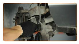
19 Trennen Sie den Bremsschlauch.
