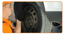
Lösen Sie die Bremssattel-Haltefeder. Verwenden Sie einen flachen Schraubendreher.
