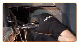
Lösen Sie die Bremsschlauchbefestigung. Verwenden Sie einen offenen Ringschlüssel #14.
