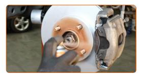
Die Bremsscheibenoberfläche reinigen. Benutzen Sie einen Bremsenreiniger.
