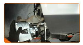
Installieren Sie die Staubschutzkappen der Bremssattel-Führungsstifte.
