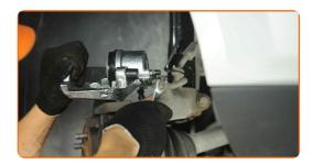
Entfernen Sie die Klammer des Bremsschlauchs.
