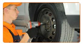
Senken Sie das Auto und ziehen Sie die Radschrauben über Kreuz an. Verwenden Sie eine Schlagnuss für Felgen # 19. Verwenden Sie einen Drehmomentschlüssel. Ziehen Sie ihn mit 120 Nm Drehmoment fest.
