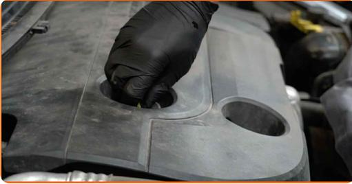
**42** Befestigen Sie den Deckel des Öleinfüllstutzens.
