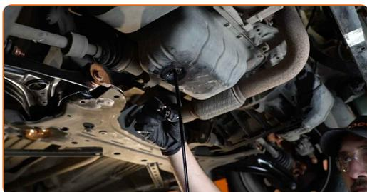
**Austausch: Motoröl und Ölfilter – FORD Transit Courier Kastenwagen. Tipp:**
