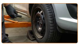
Lösen Sie die Radhalterungsschrauben. Verwenden Sie eine Schlagnuss für Felgen # 19.
