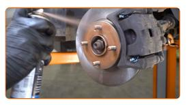
Die Bremsscheibenoberfläche reinigen. Benutzen Sie einen Bremsenreiniger.
