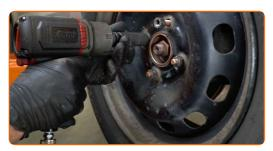
Senken Sie das Auto und ziehen Sie die Radschrauben über Kreuz an. Verwenden Sie eine Schlagnuss für Felgen # 19. Verwenden Sie einen Drehmomentschlüssel. Ziehen Sie ihn mit 110 Nm Drehmoment fest.
