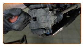
Entfernen Sie den Bremssattel.
