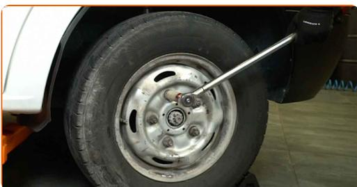
**23** Entfernen Sie den Wagenheber, die Unterstellböcke und die Unterlegkeile.
