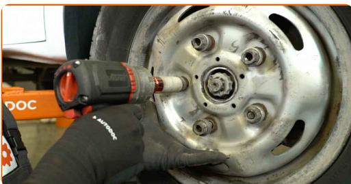
**22** Senken Sie das Auto ab und ziehen Sie die Radschrauben über Kreuz fest. Verwenden Sie eine Schlagnuss für Felgen mit einem Durchmesser von 21 mm. Verwenden Sie einen Drehmomentschlüssel. Anzugsdrehmoment: 200 N·m.
